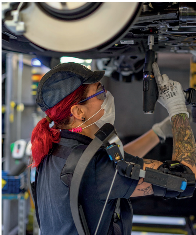
Imagen 2. Persona trabajadora utilizando un exoesqueleto para asistir en la elevación mantenida de los brazos
