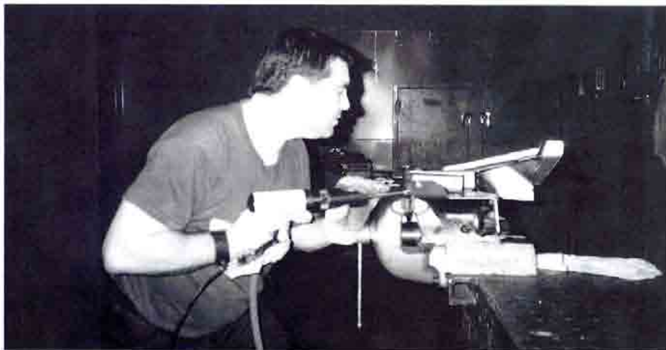
Ensayo destructivo de materiales con escoplo neumático.
