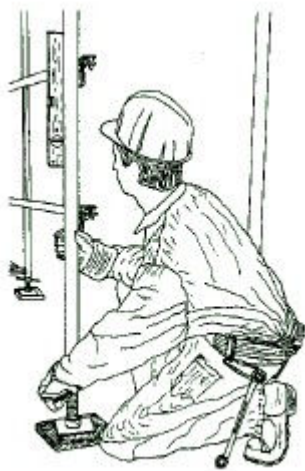
Figura 15. Comprobación de la nivelación vertical
