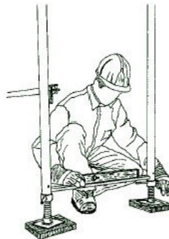
Figura 16. Comprobación de la nivelación horizontal
