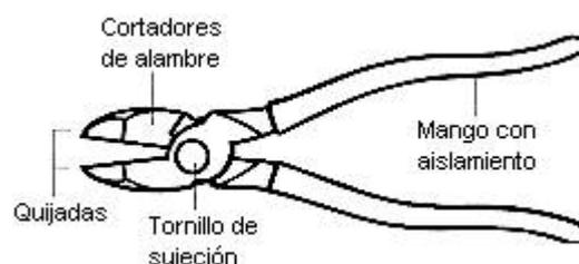
**Fig. 2: Partes de los alicates**
