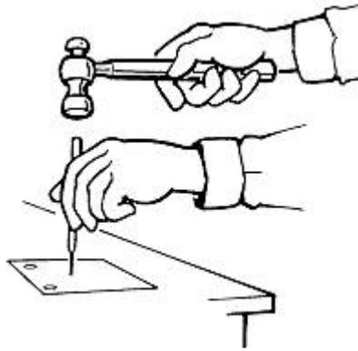
**Fig. 16: Forma correcta de utilizar un punzón**
