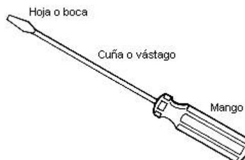
**Fig. 11: Partes de un destornillador**
