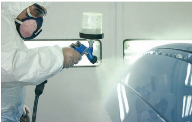
Aplicación de barniz con equipo de alta transferencia
