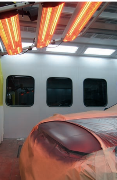
El secado en la zona de preparación evita movimientos de vehículos
