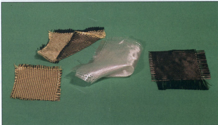
Fibras utilizadas en los materiales compuestos: vidrio (blanca), carbono (negra), kevlar (amarilla).
