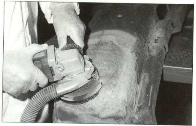
Figura 2.—Empleo de máquina lijadora con extracción.
