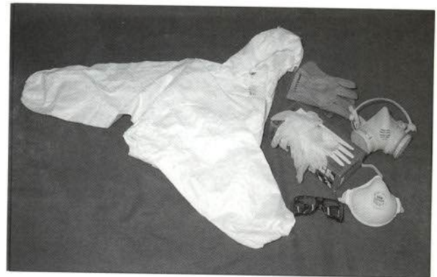
Figura 4.—Equipos de protección.
