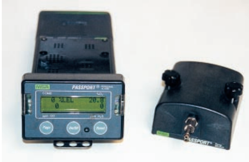
Bomba de aspiración acoplable al detector continuo
