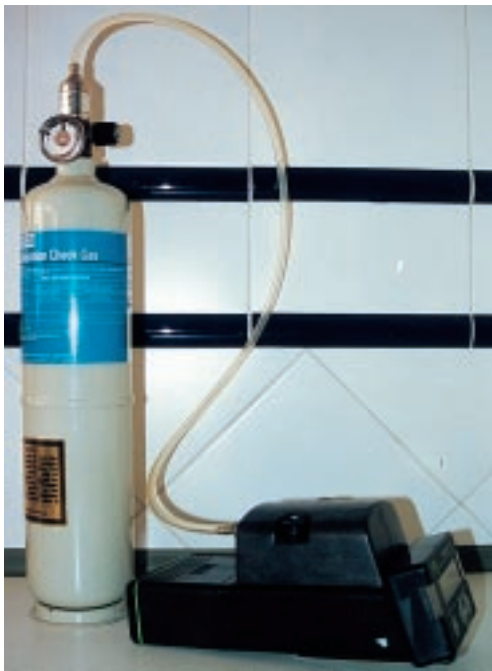
Equipo de calibración con acoplamiento directo de la botella de gases a la bomba de aspiración del detector
