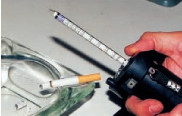
Medición puntual con tubo detector colorimétrico específico para CO 2
