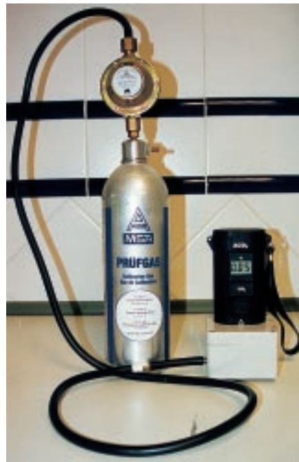
Equipo de calibración con encapsulamiento del sensor del detector
