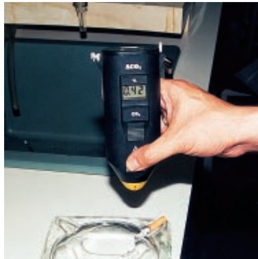
Medición con detector continuo de CO 2 , con alarma óptica y acústica
