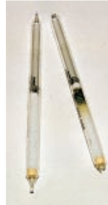
Medición con tubo detector genérico cualitativo (Politest, Qualitest, ...)
