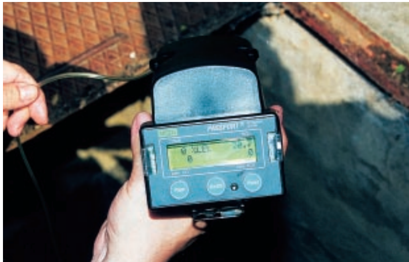
Medición simultánea del índice de explosividad, y de los contenidos de oxígeno, monóxido de carbono y sulfuro de hidrógeno
