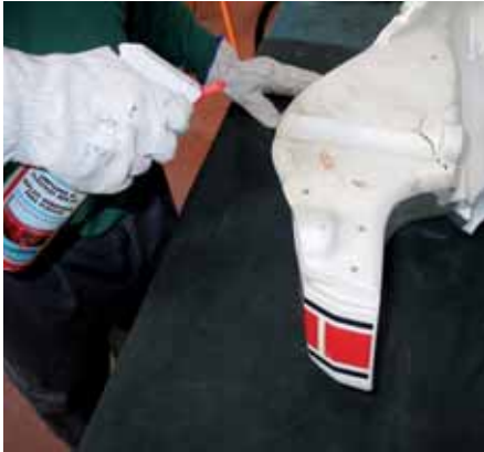
► Eliminación de la pintura
