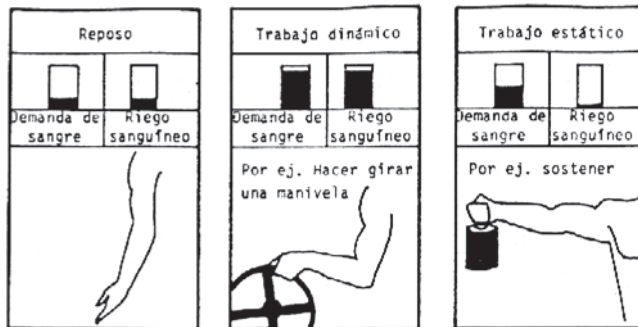
Figura 2.4. Riego sanguíneo de los músculos en trabajo dinámico y estático (según Lehmann).
