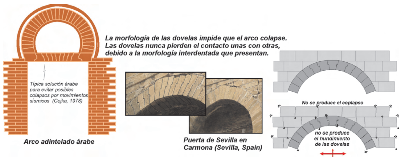
Figura 6.15. Los engatillados aparecen con cierta frecuencia en arcos y dinteles de puertas y ventanas, como solución a posibles desplazamientos de las dovelas por movimientos horizontales. Era una solución muy aplicada en la cultura árabe en España para evitar posibles colapsos de este tipo de estructuras por movimientos sísmicos (Cejka, 1978). Un claro ejemplo de la utilización de dovelas engatilladas lo podemos encontrar en un arco de época almohade de la Puerta de Sevilla en Carmona (Sevilla, España).
