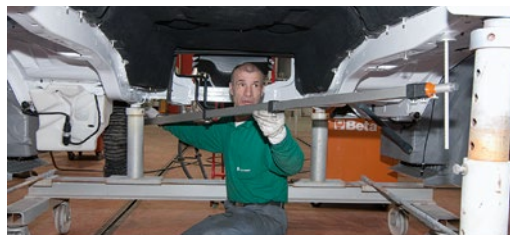
► Control dimensional de los largueros inferiores de la cabina
