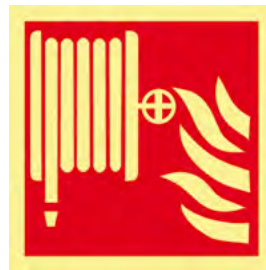
Boca de incendio equipada
