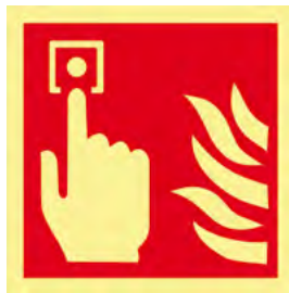
Pulsador de alarma
