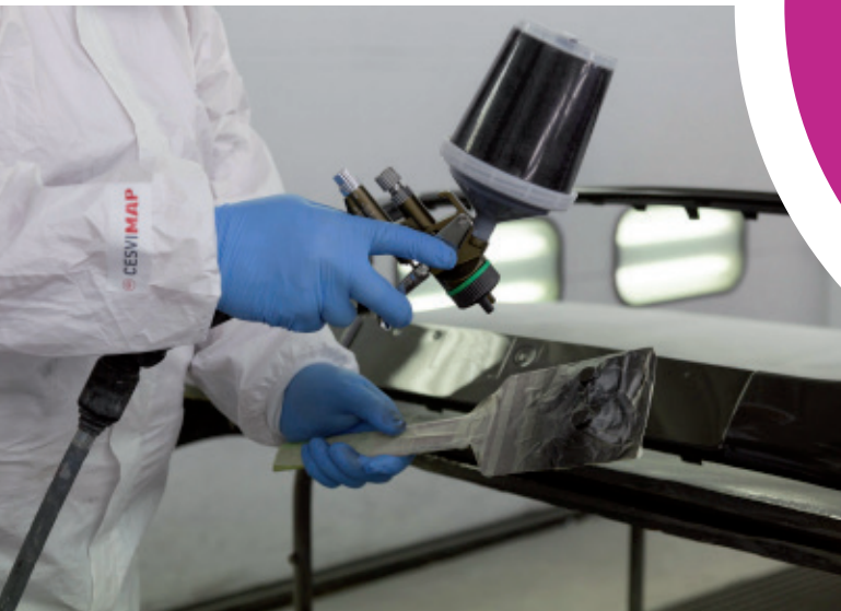
Pintado de los sensores (base bicapa)
