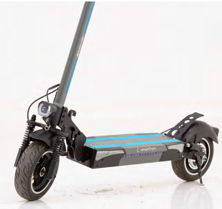
Dobles amortiguadores delanteros y traseros
