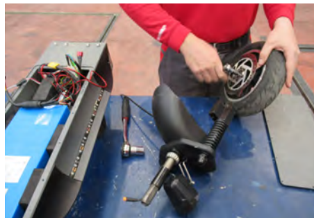
Extracción de las pastillas de freno. A la derecha, pinza de freno y pastilla.
