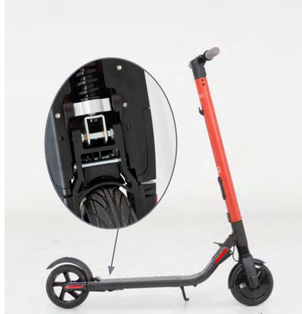
Amortiguador delantero integrado en la columna de dirección y trasero en la base del patinete
