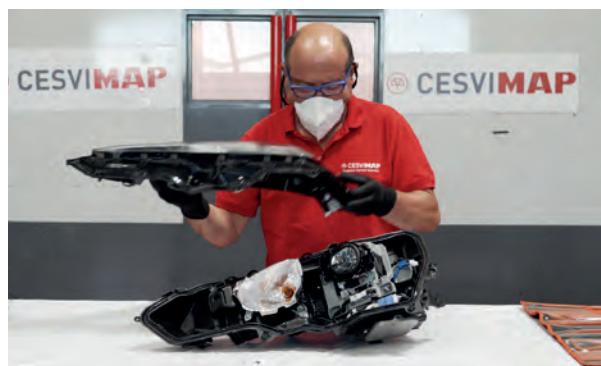
Separación de carcasa y tulipa
