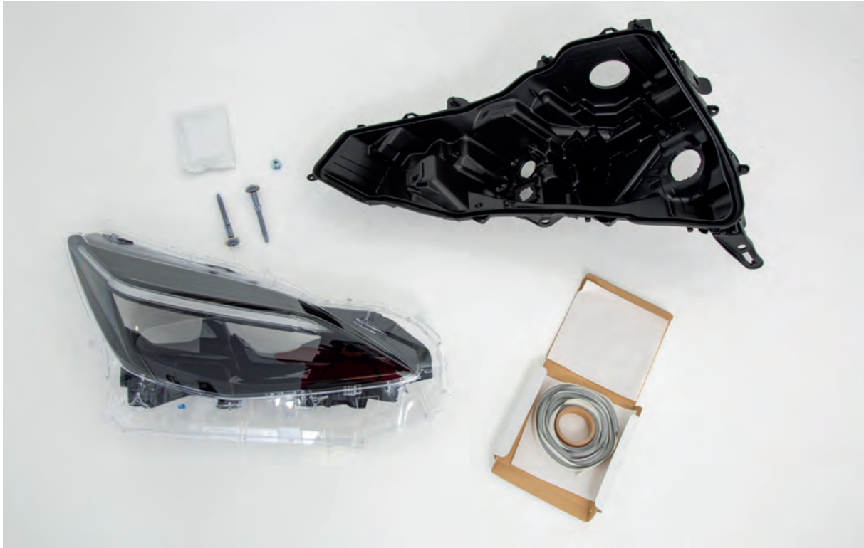
Despiece del faro, tal cual suministra el fabricante el recambio
