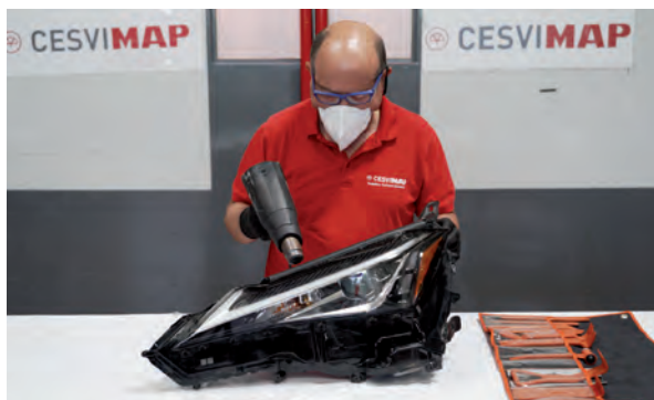
Aplicación controlada de calor
