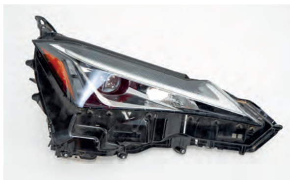
Faro con la tulipa ya cambiada
