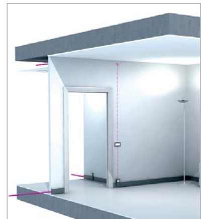
Falso techo en los pasillos y rozas verticales en los paramentos.
