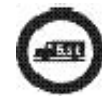
R-107 Entrada prohibida a vehículos destinados al transporte de mercancías con mayor masa autorizada que la indicada
