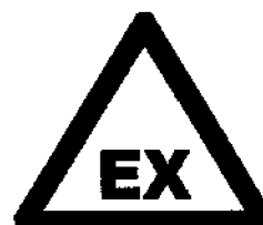
Zona con riesgos de atmósferas explosivas
