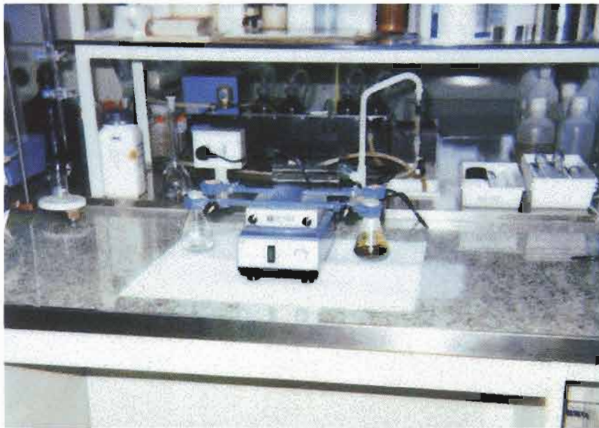
Agitador automático: Proceso de extracción con agitación brusca y prolongada
