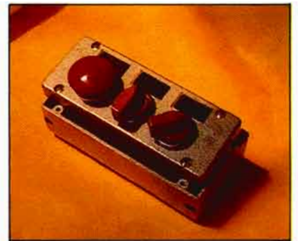
Fig. 6. —Elementos de mando provistos de consola. Los órganos de accionamiento son bien accesibles. Los bornes son inaccesibles por quedar dentro de la consola, que, en este caso, una vez montada, proporciona un grado de protección IP 65.
