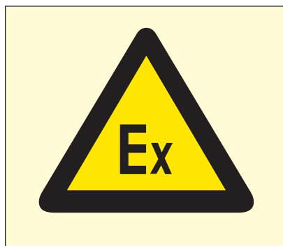
FIGURA 2. Señalización de zonas con riesgo de atmósferas explosivas según la Directiva 99/92/CEE. Anexo III.
