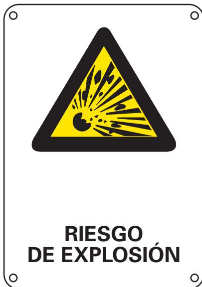
FIGURA 3. Señalización de materias explosivas según Real Decreto 485/1997 sobre disposiciones mínimas en materia de señalización de seguridad y salud en el trabajo. Anexo III.
