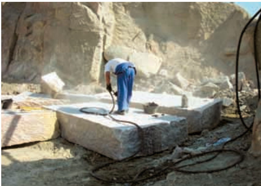
Operario haciendo un «perpiaño» (losa rectangular de grandes dimensiones).
