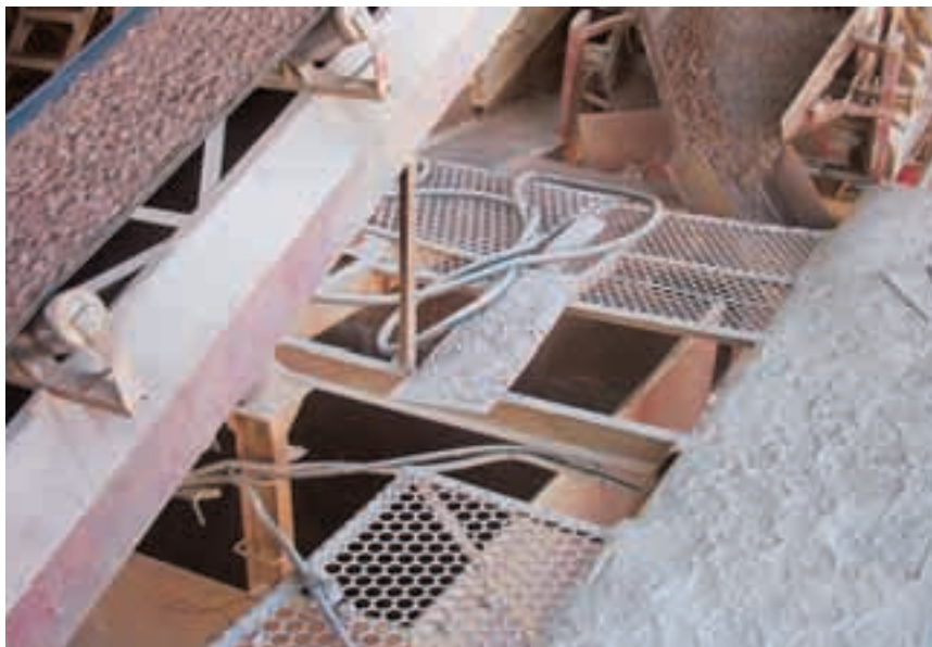
Polvo depositado en uno de los huecos de la tolva del molino.
