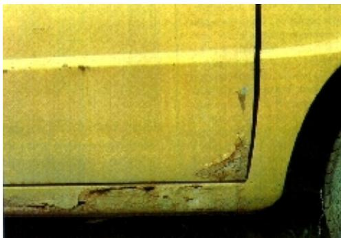
Aún siendo uniforme, si el medio es muy agresivo en poco tiempo la disminución del espesor en el objeto metálico en él es tal que se pierden sus características mecánicas, por lo tanto, en muy pocas ocasiones es recomendable utilizar un metal sin ninguna protección dejándolo a corrosión libre y, cuando se hace, no hay que olvidar sobredimensionar de forma adecuada.
