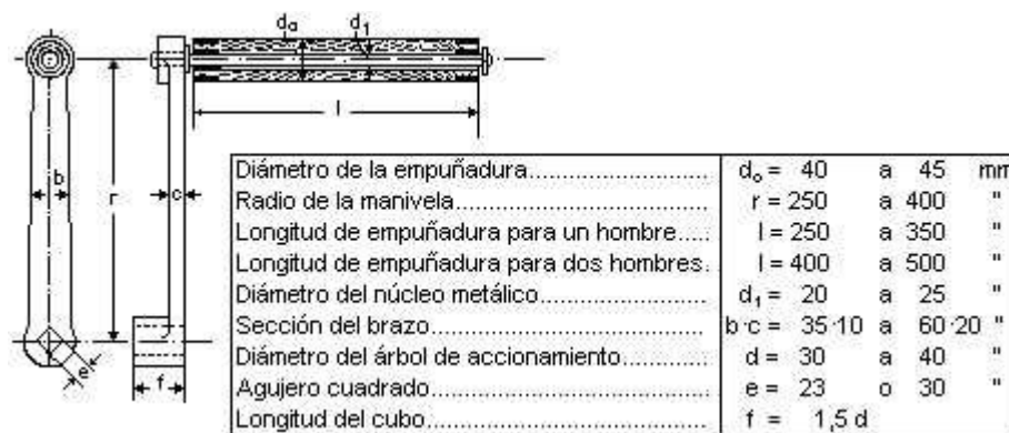
Fig. 3: Manivela simple
