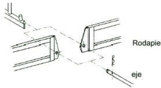
**Figura 4. Acoplamiento de módulos y liras**
