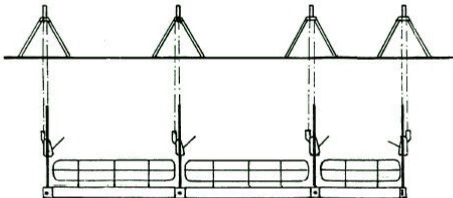
**Figura 3. Andamio colgado con tres módulos y cuatro pescantes**
