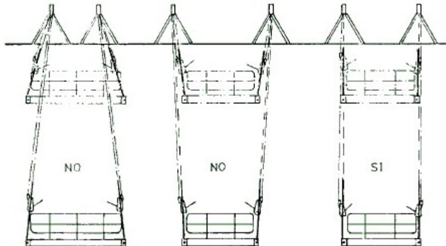
**Figura 8. Colocación de pescante. Ejemplos prácticos**
