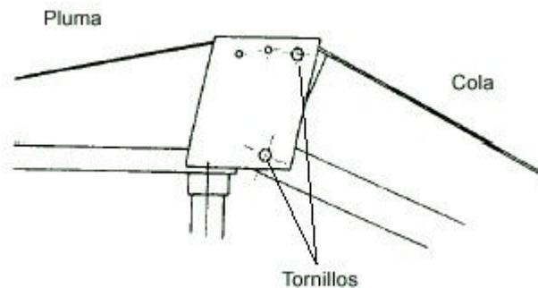
**Figura 9 Unión entre la pluma y la cola de un pescante**
