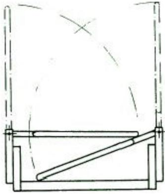
**Figura 6. Despliegue de las barandillas.**
