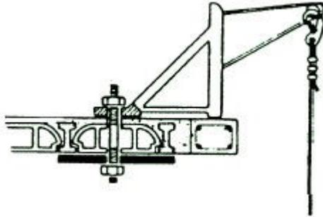
**Figura 1. Pescante anclado al forjado**
