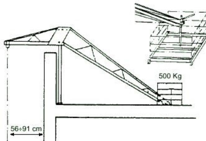
**Figura 2. Pescante anclado mediante contrapesos**
