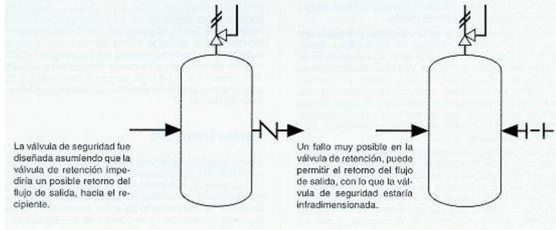
Figura 4d. Infradimensionado de la válvula de seguridad ante un cambio en las condiciones de operación
