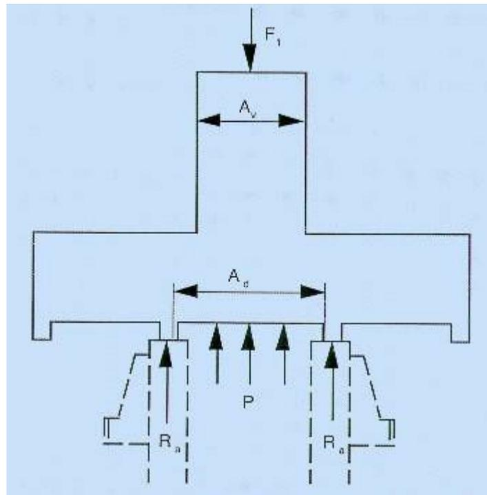
**Fig. 3: Balance de fuerzas sobre el disco de cierre de la válvula de seguridad**
