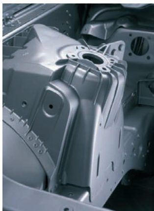
Pieza de fundición: torre de suspensión
