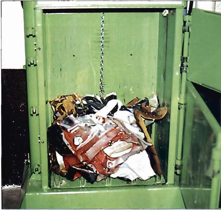
Cuando el recipiente se completa, se acciona el interruptor de corriente y el botón de prensado.
