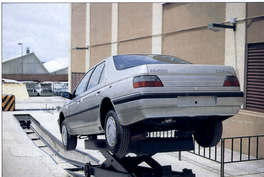
El golpe de rampa permite estudiar la deformabilidad de los coches nuevos.
