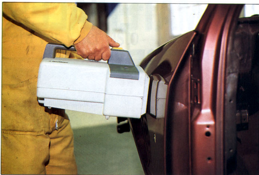
El Delta-E Crom mide el color de la misma carrocería con precisión electrónica.
