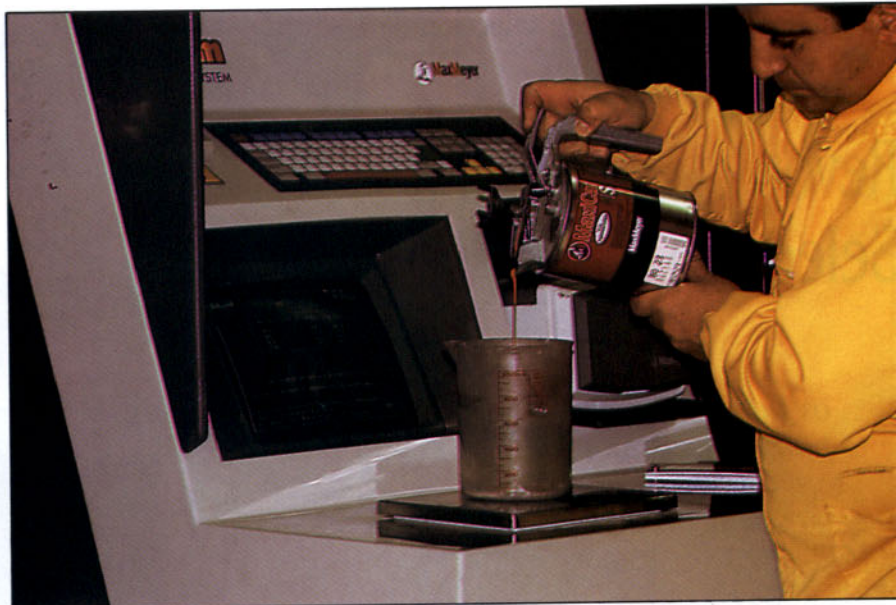
La preparación del color exacto ha sido facilitada por un equipo informatizado de selección de colores.
