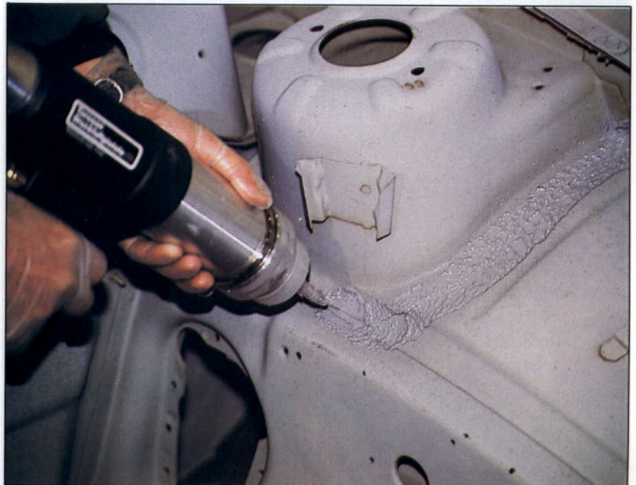
Sellado de estructura rugosa.
