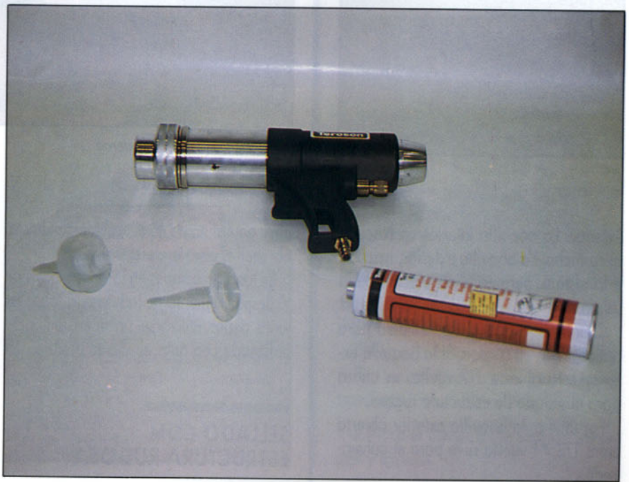
Terostat 9320 y pistola neumática Teroson SN.
