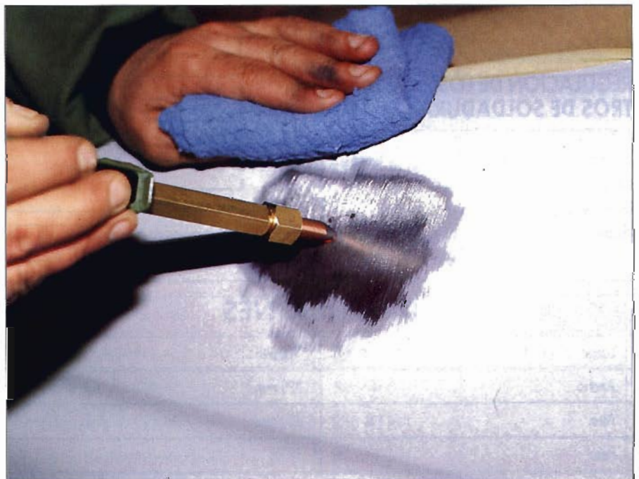
Recogida de chapa con electrodo de carbono.
