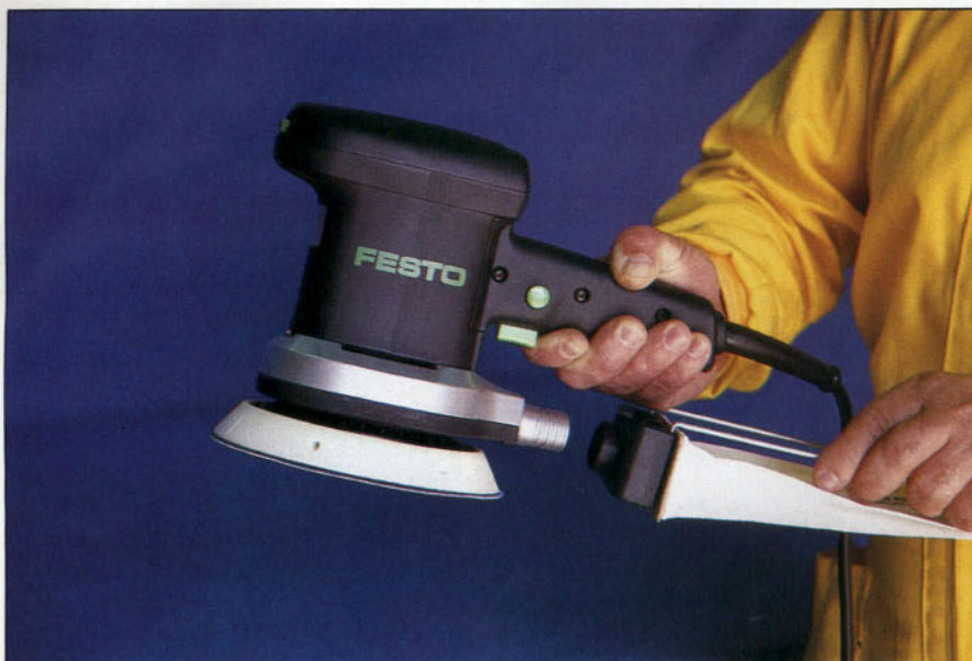
Montaje de un filtro
