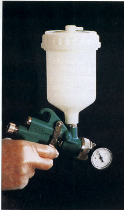
Comprobación de la presión en punta de pistola
