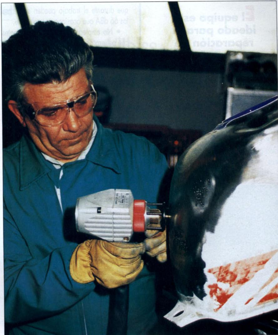
Reparación de un depósito de combustible previamente desgasificado.
