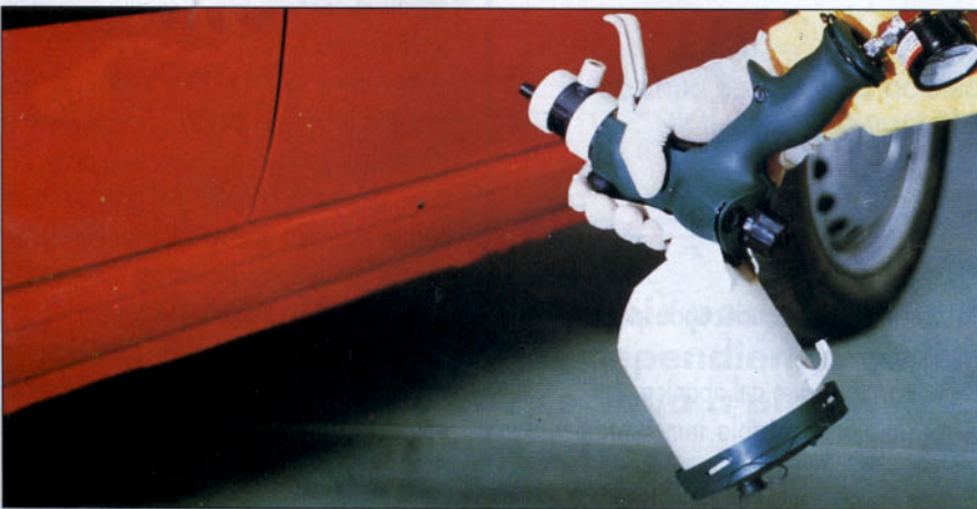
Posiciones de uso para pintar superficies horizontales, verticales y zonas bajas.
