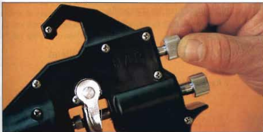
Regulación de producto y anchura de abanico.
