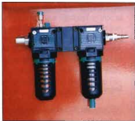
Detalle del filtro y lubricador de aire.
