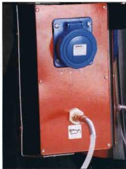
Detalle de la toma de conexión.
