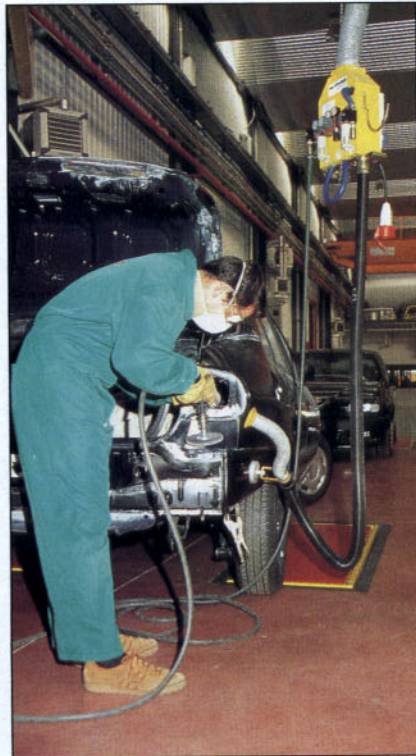
Uso combinado de aire comprimido y aspiración de polvo.
