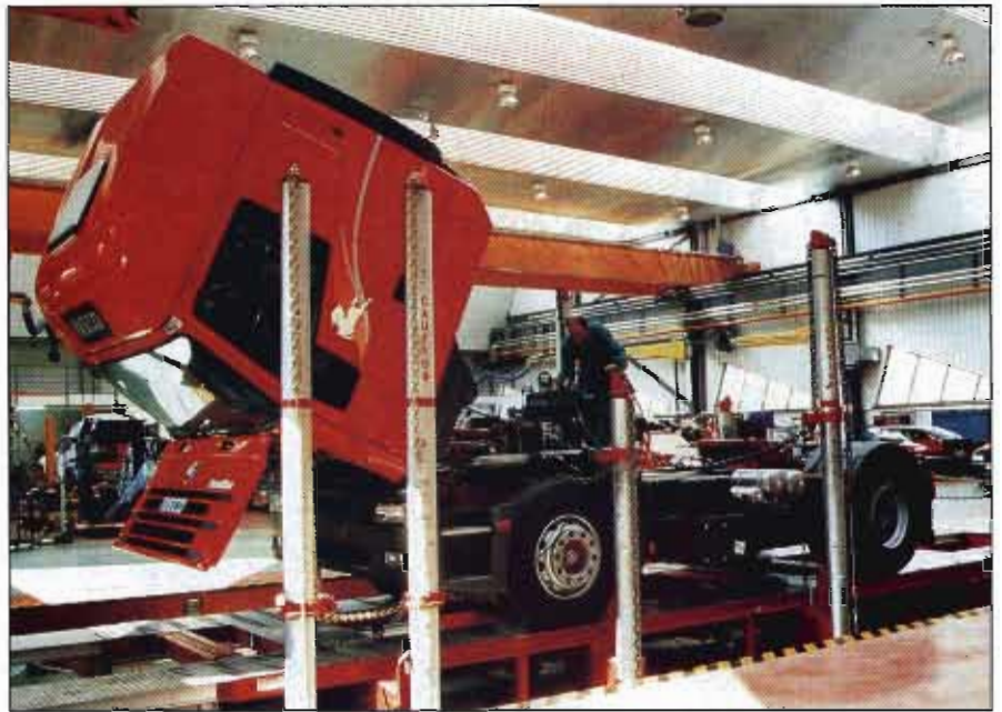
Reparación en bancada de plataforma con torres de tracción.
