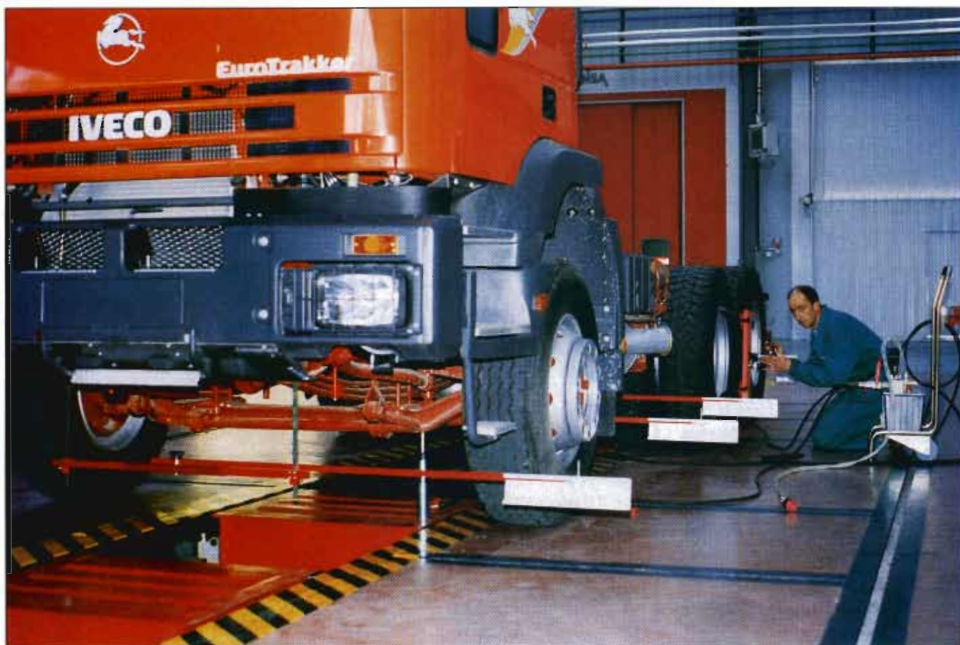
Medición del desplazamiento lateral del chasis.
