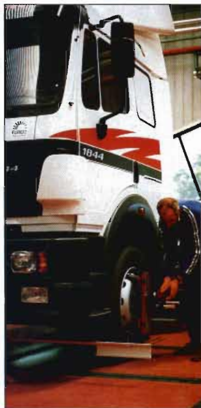
Medición del ángulo de caída o CÁMBER en el eje delantero.
