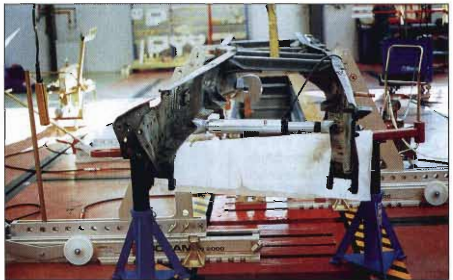
Bancada de vigas empotradas en el suelo con foso.
