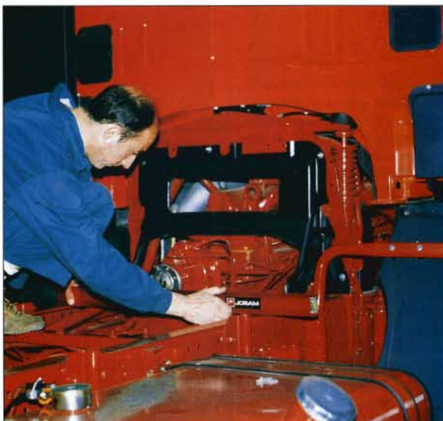
Medición del desplazamiento vertical del chasis
