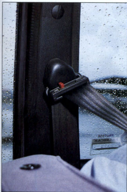
La utilización de pinza reduce la eficacia del cinturón.
