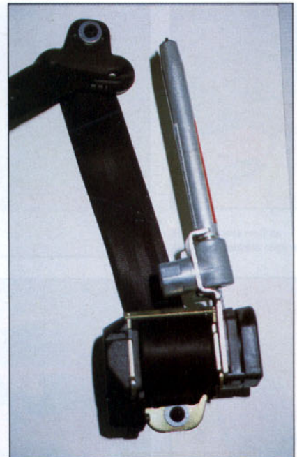
Mecanismo del pretensor del cinturón.
