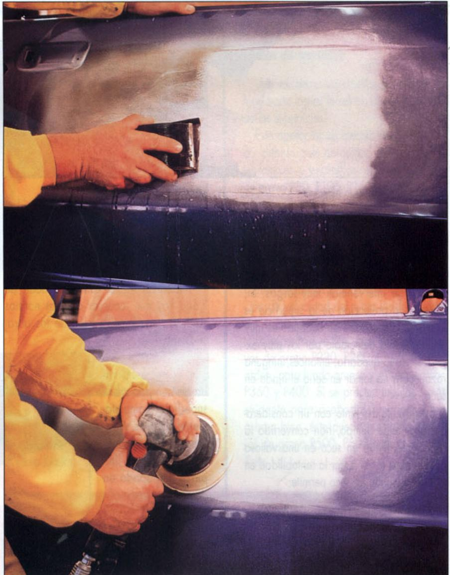
**A**ctualmente, y en un proceso de repintado, los tiempos de lijado suponen aproximadamente un 55% del total del tiempo necesario. Aquí estriba una de las razones fundamentales por la que los fabricantes de equipos y productos han hecho grandes esfuerzos de investigación para ofrecer métodos y tecnologías alternativas al tradicional lijado manual al agua.
