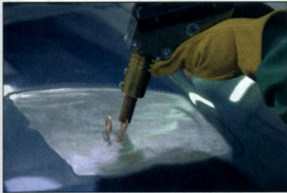
Soldadura de arandelas.
