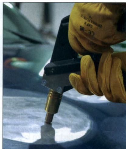
Aplicación de tratamientos térmicos con electrodo de cobre.
