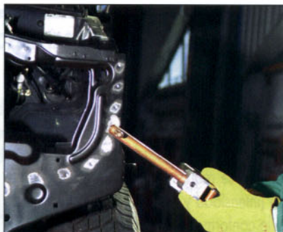
Soldadura por puntos de resistencia.
