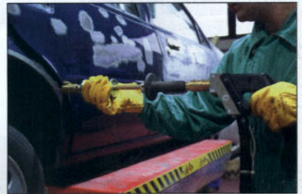
Empleo de martillo de inercia con cabeza de desabollado rápido.
