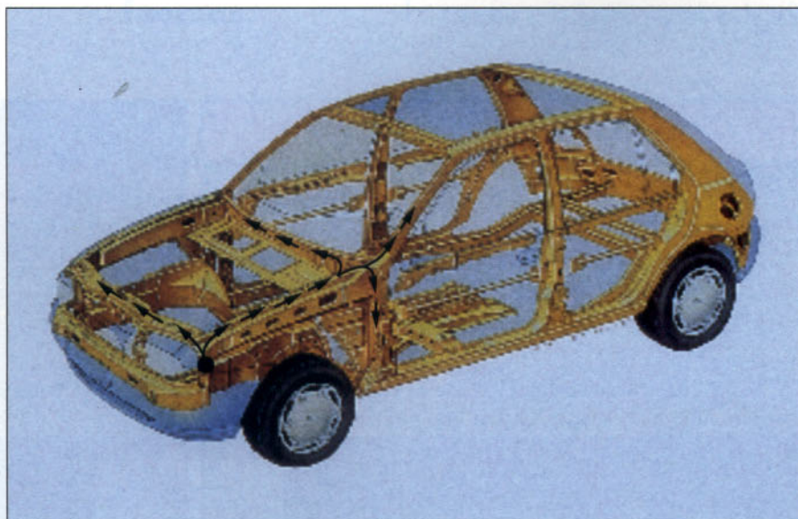
El diseño de la carrocería transmitirá la fuerza del impacto.
