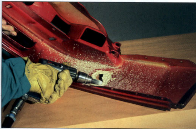
Lijado y achaflanado de la rotura.
