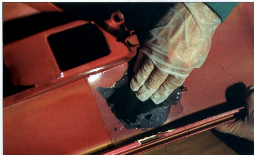
Colocación de una lámina termoplástica.
