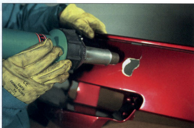
Eliminación de deformaciones mediante calor.
