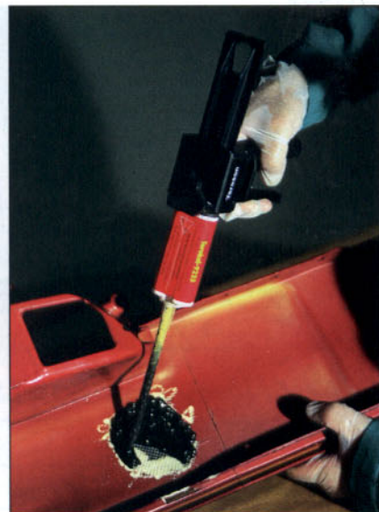
Aplicación del adhesivo.
