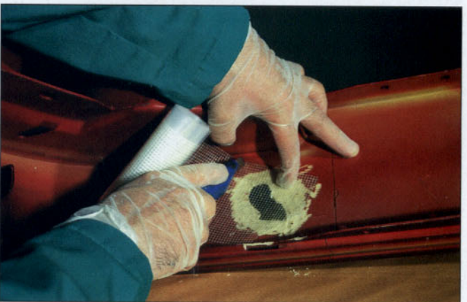
Corte y colocación de la tela de refuerzo.
