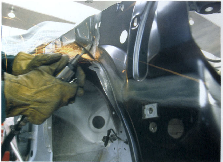
Lijado de un cordón de soldadura
