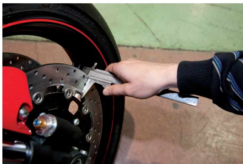
► Ajuste de la inclinación de la maneta del freno delantero y control del desgaste del disco de freno
