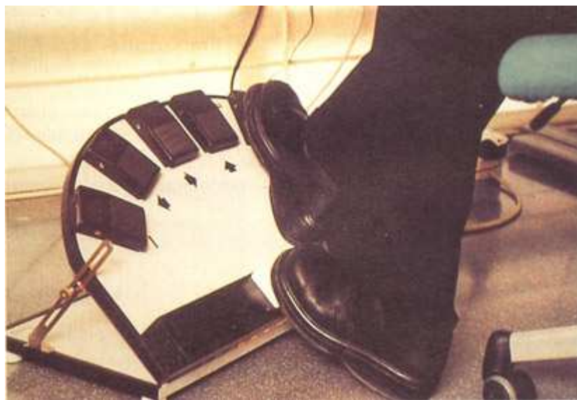
Figura 2. Sistema de control de movimiento del ratón del ordenador mediante pulsador de pedales. (Fuente: ONCE)
