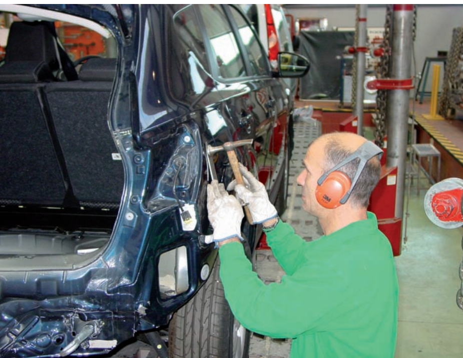
Reparación de costado en CESVIMAP
